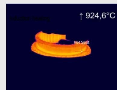
Chauffage par induction
