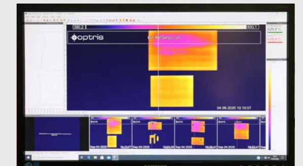
Surveillance des températures de feuilles de verre
