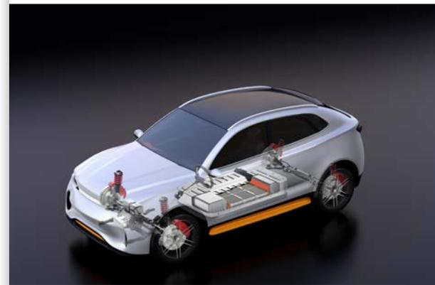
Pack batterie au lithium dans une voiture électrique
