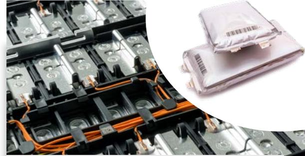
Pack batteries au lithium pour voiture électrique et câblage
