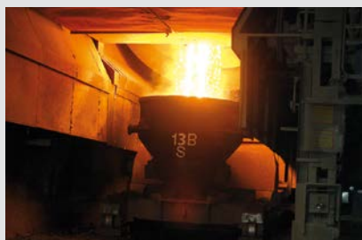
Surveillance du revêtement réfractaire d'un wagon poche et scorie se retirant de l'usine
