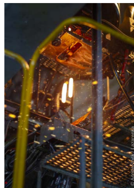
Surveillance de température de gouttes de verre en fusion avec la caméra thermique PI 1M
